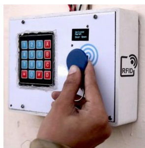
Рис. 2 – Зовнішній вигляд системи smart lock з використанням RFID і ESP32.
